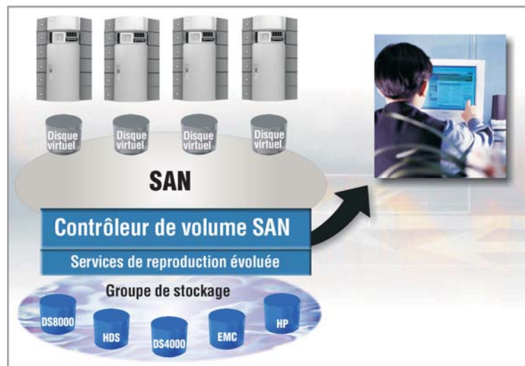
Figure 1 – Le SVC aide à combiner la capacité de divers systèmes de stockage, à fournir des fonctions de copie commune, à permettre le mouvement de données sans interruption du serveur et à prendre en charge la gestion de divers dispositifs de stockage à partir d'un point unique.
